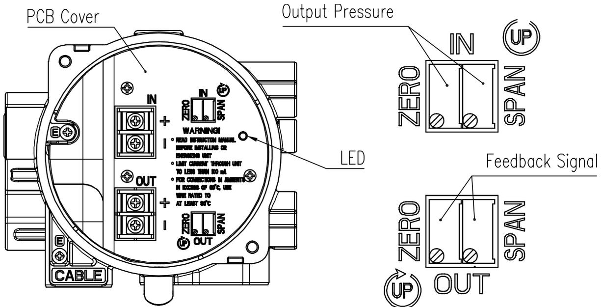
Fig. 6-1: Zero, Span
